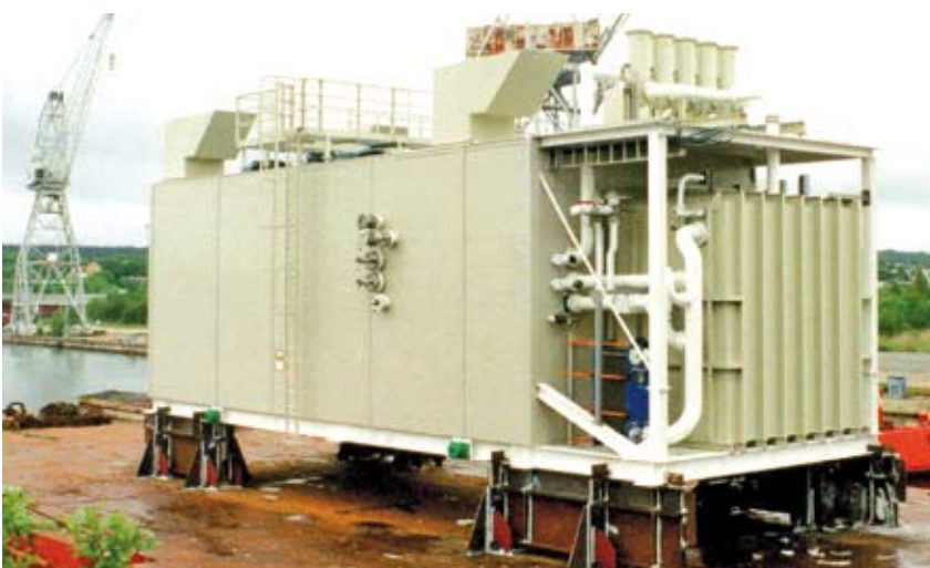
En 7 MW Hydraulic Power Unit, tegnet, konstruert og bygget av Jotne. Enheten produserer kraft til boreplattform.
