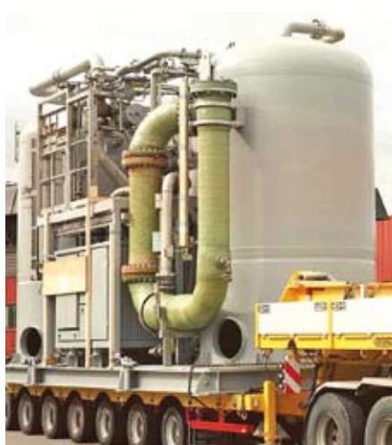
Bildene over viser en av to vannbehandlingspakker som Jotne var ansvarlig for å detaljkonstruere og produsere frem til ferdig testede pakker. Pakkene står nå på Bongaplattformen utenfor Vest-Afrika.
