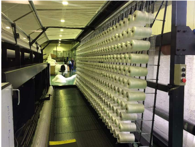
Automatisert og robotisert produksjon av fiskegarn.
