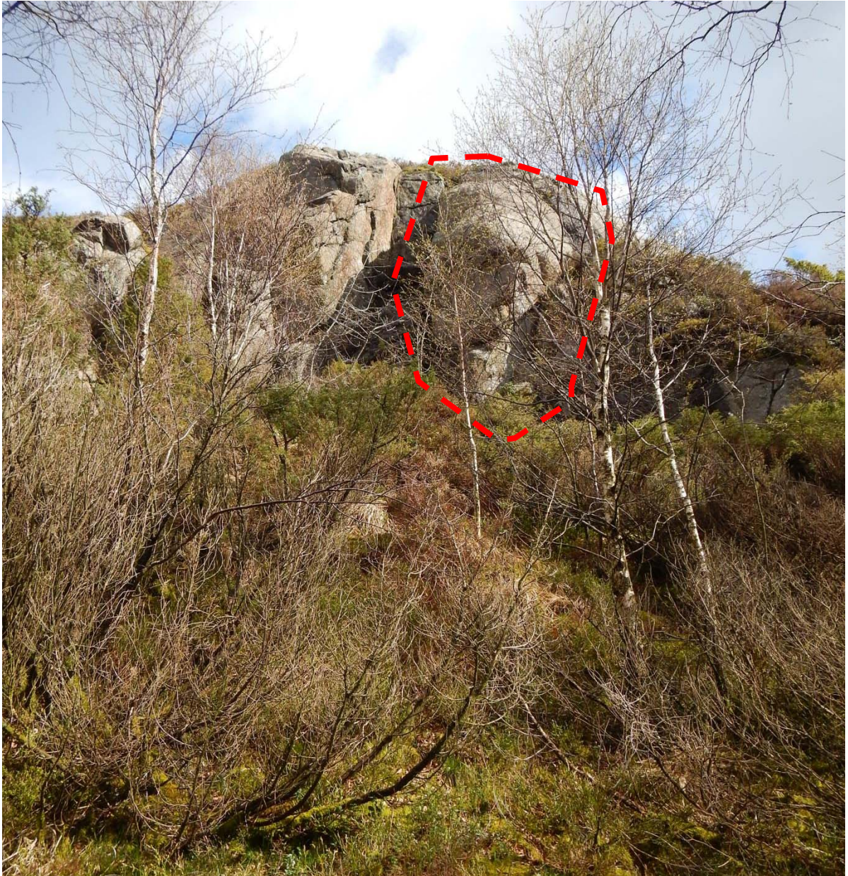
Foto 4: Bilde fra lokalitet 3. Rød sirkel markerer en stor blokk med usikker stabilitet.
