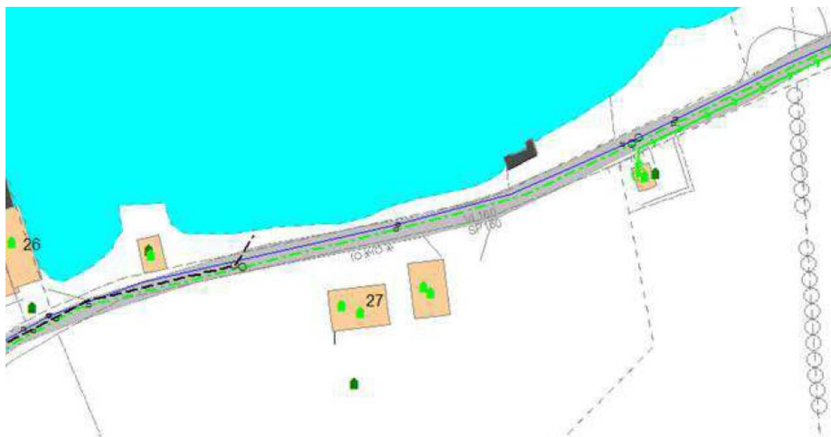
Figur 13 - Utsnittet viser vann-, spillvann- og overvannsledninger
