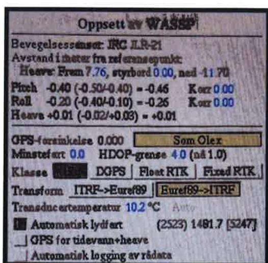
Figur 2: Oppsett av WASSP. Figuren viser et bilde av innstillinger benyttet ved kartlegging (Eirik Sundsfjord, pers. komm. 2018).
