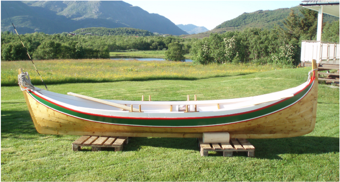
Nordlandsbåt av sitkagran bygd av Tore Kornbakk på Sortland med båtbord fra skogen til Tor Andersen i Bø og saget på Fjærvollsaga til Nils Erik Klaussen. Foto: Tor Andersen.
