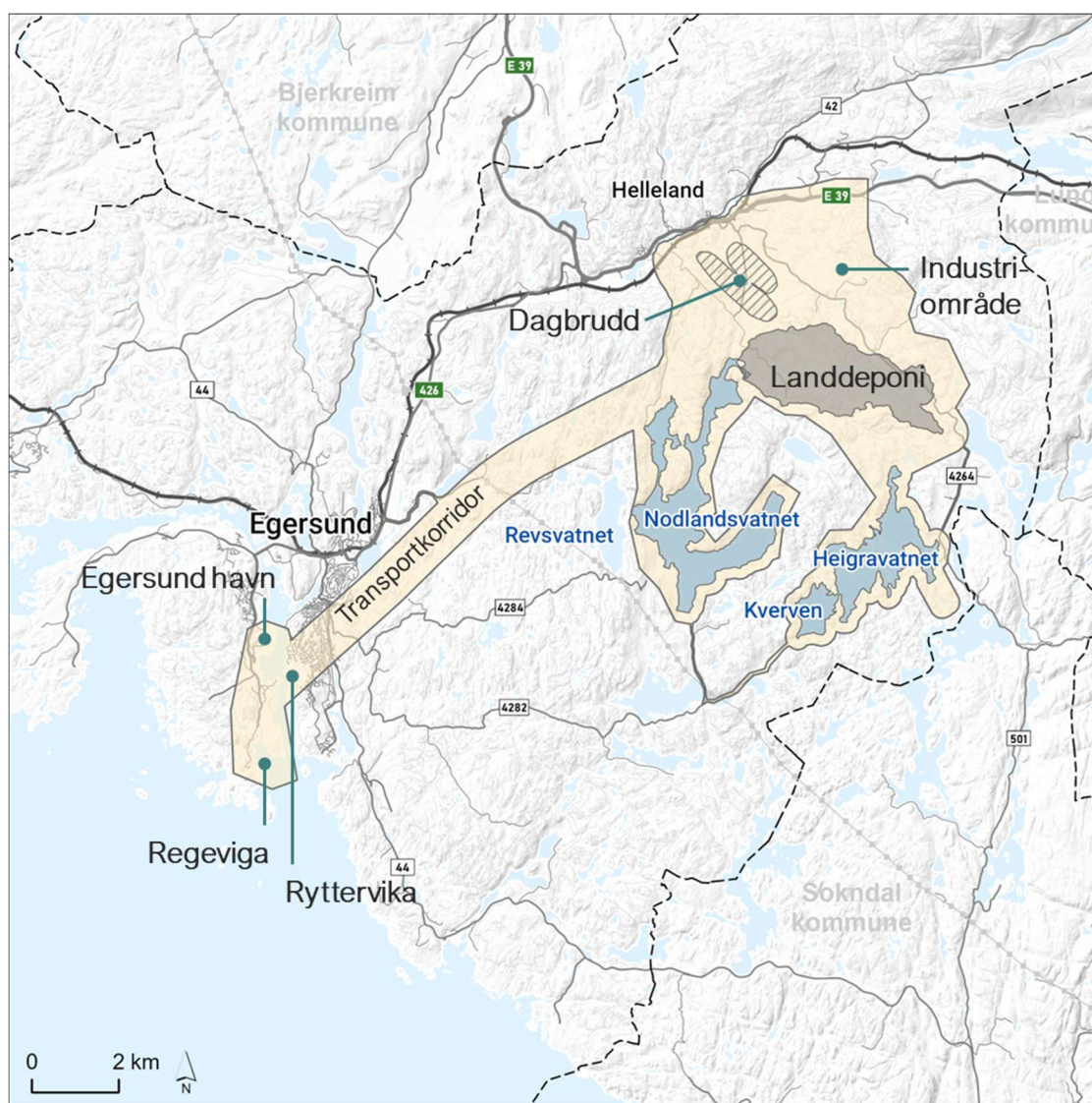
Figur 3-1 Skisse som viser planområdet med plassering av dagbrudd, alternativer for deponier på land (tørredeponi) og i vann (Heigravatnet, Kverven og Nodlandsvatnet), samt transportkorridor og alternativer for utskipningshavn ved Eigersund by og på Eigerøya.
