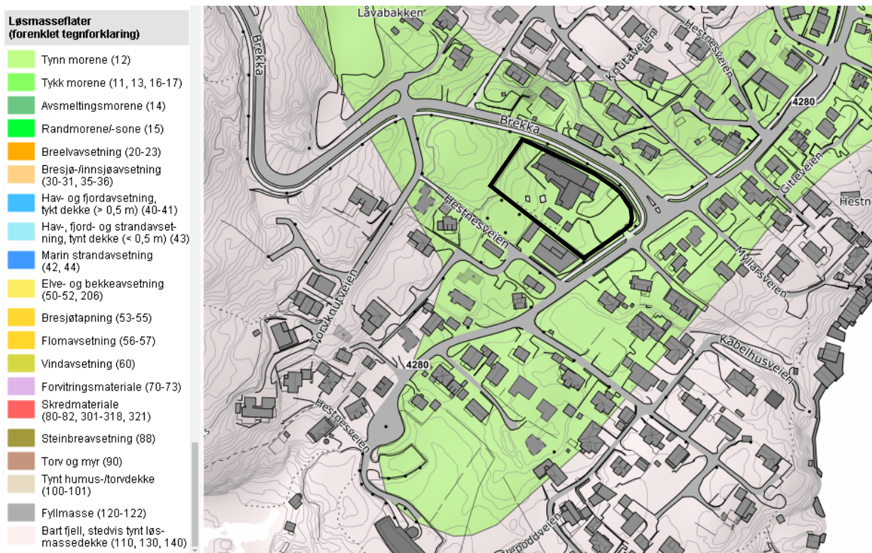
Figur 13: Løsmassekart viser at området består av tynn morene. Planområdet er innenfor svart strek. Kartkilde: NGU løsmassekart.
